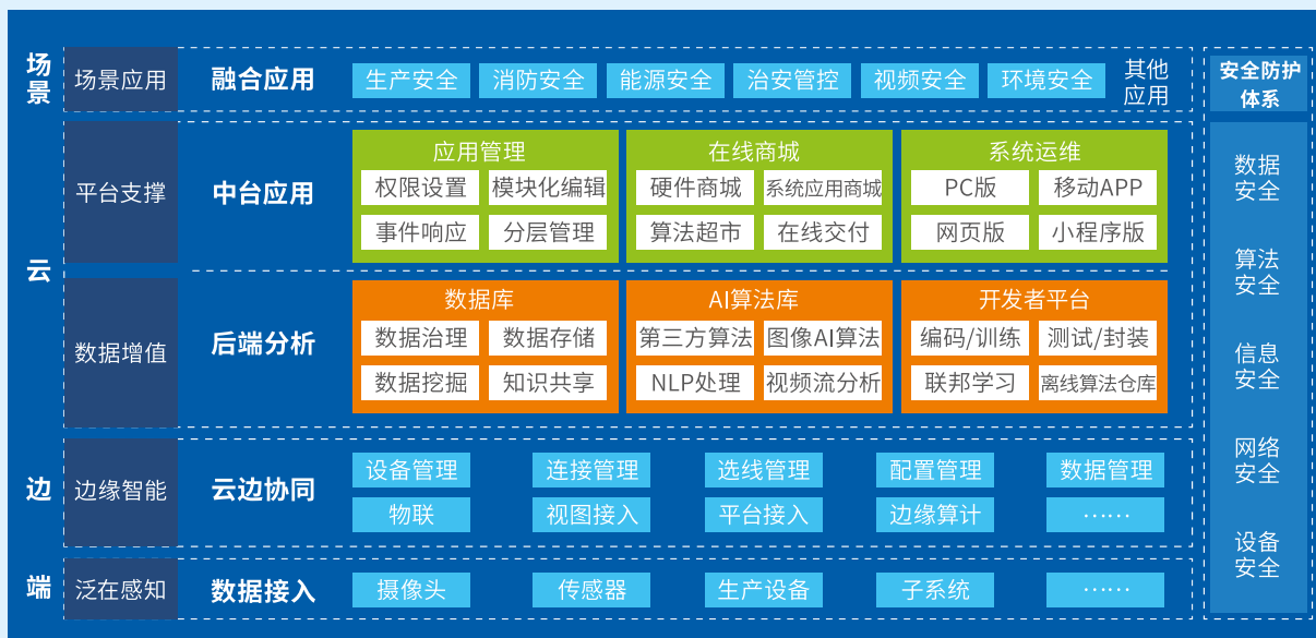
图1: (端边云) +1 (安全) +N (场景) 平台应用架构
