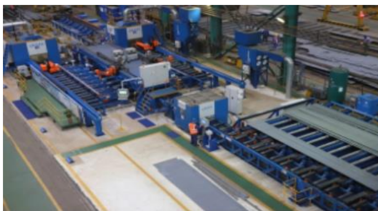
图 16 条材切割生产线
