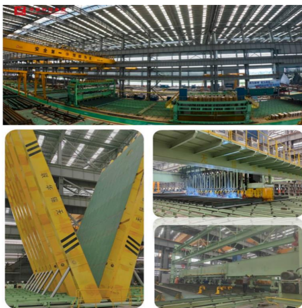
图 21 平面分段生产线
