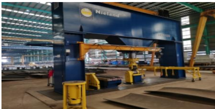
图 20 曲面辊压流水线
