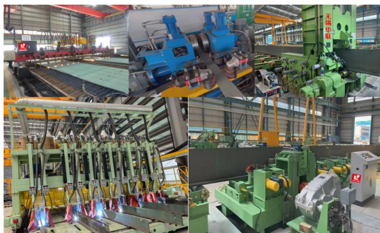
图 19 T 型材装焊生产线
