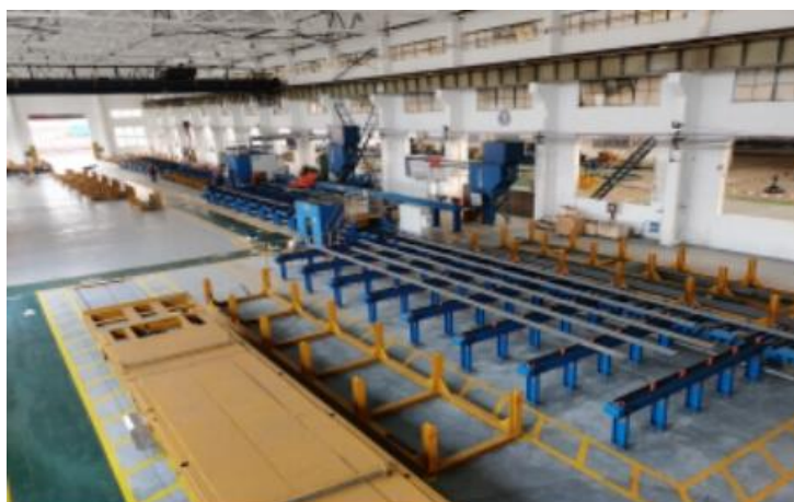
图 17 型材切割生产线
