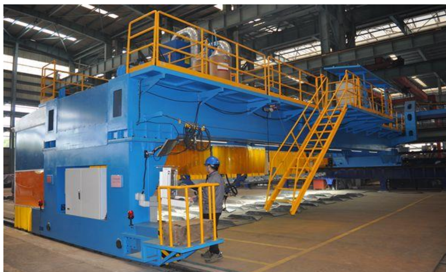
图 36 视觉智能识别船舶小组立全自动焊接机器人
