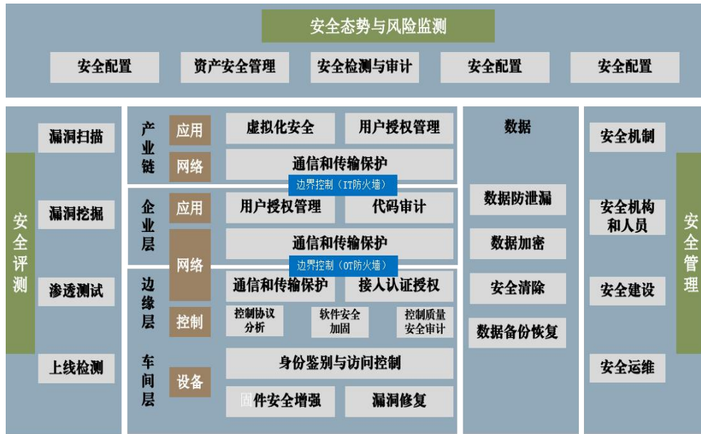
图 2-安全功能架构图
