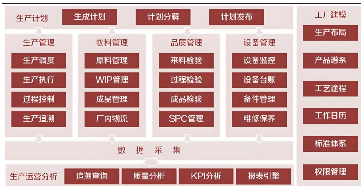
图 48- MES 系统架构
