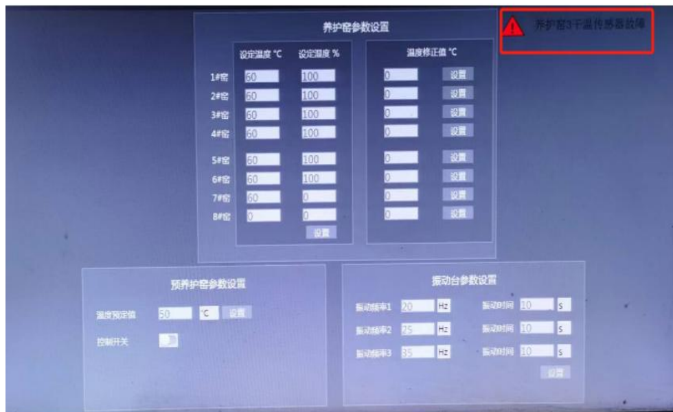
图 20-设备故障预警监控界面
