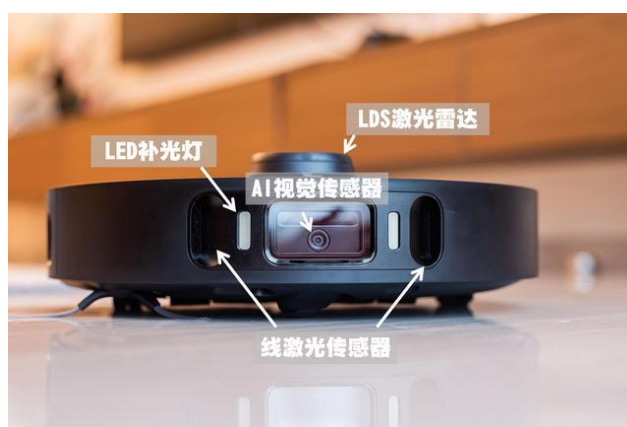
图 4 某企业扫地机器人结构示意图
