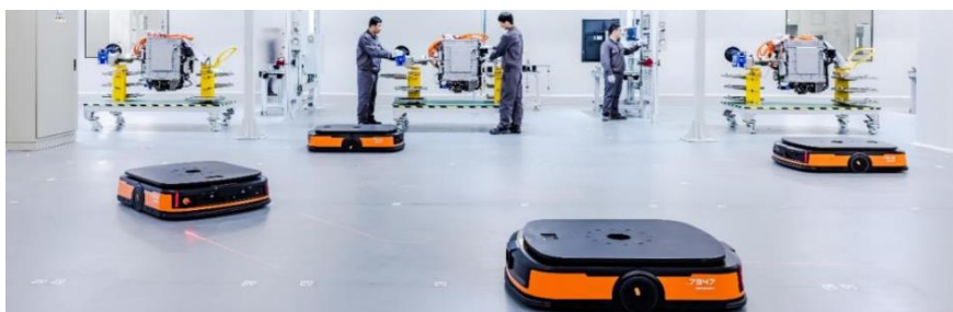
图 20 AGV 搬运自动化小车
