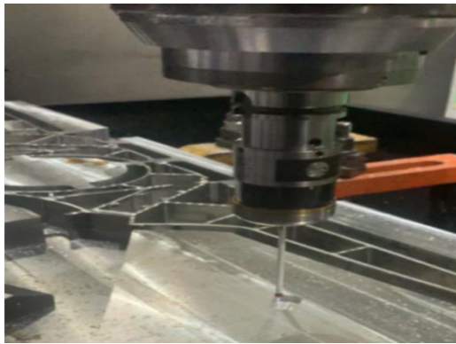
图 24 加工零部件在机测量
