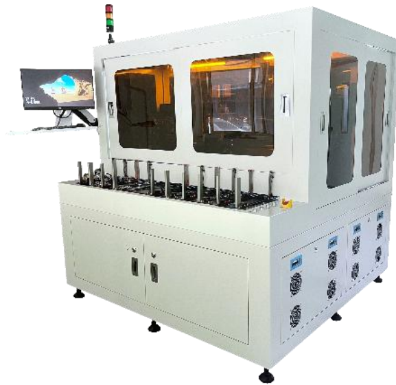
图 4 芯片外观检测设备
