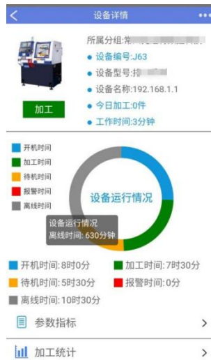
图 15 设备运行移动端实时查看
