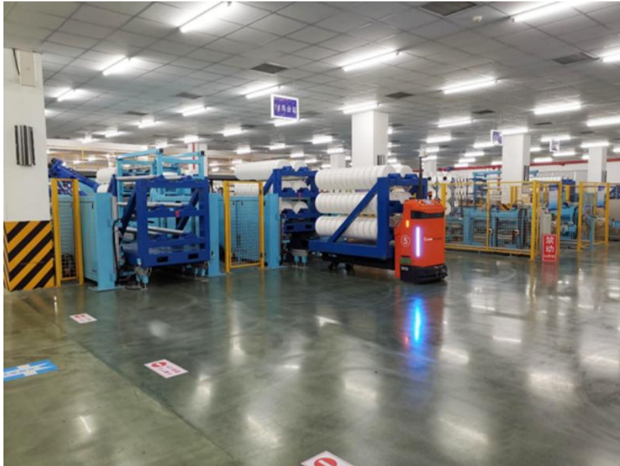
图 19 木牛流马无人叉车化学纤维行业自动化产线应用
