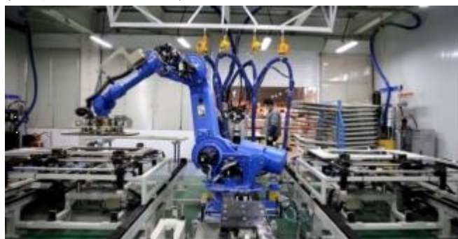
图 4-15 柔性窗框焊接自动线
