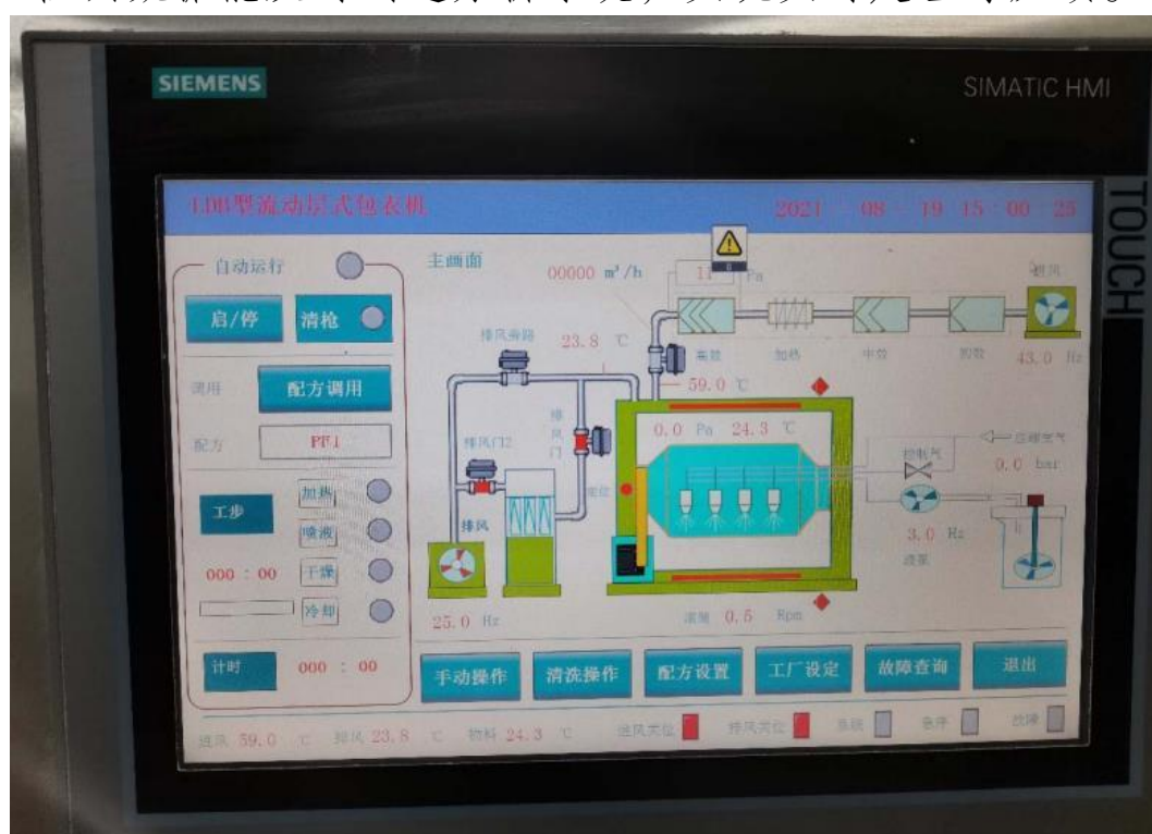
图 20：某企业包衣在线检测实时图
