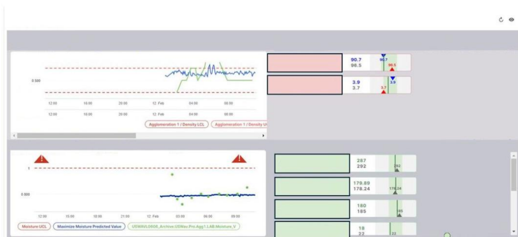
图 24：操作仪表盘显示密度和水分的预测值和实际值
