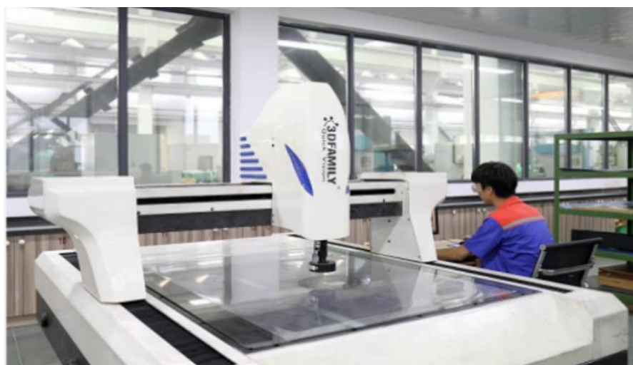
图 32 三坐标表测量仪在线检测
