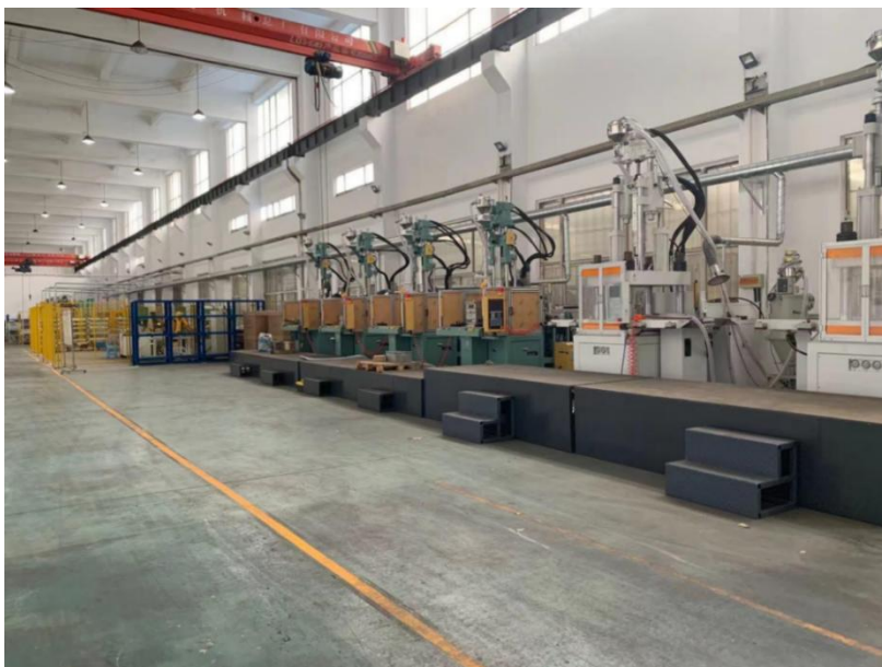
图 42 定转子包塑流水线
