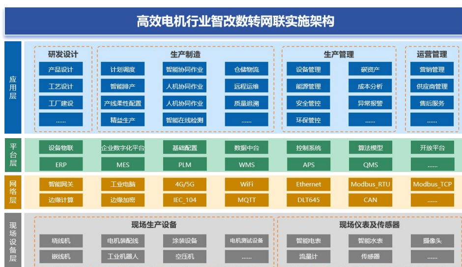
图 6 高效电机行业智改数转网联实施架构示意图
