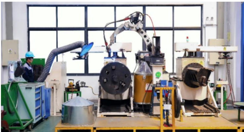
图 20 冲片与焊接工艺应用多轴机器人
