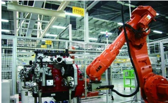
图 4.8 ( 1 ) -柔性生产单元机械臂上料
