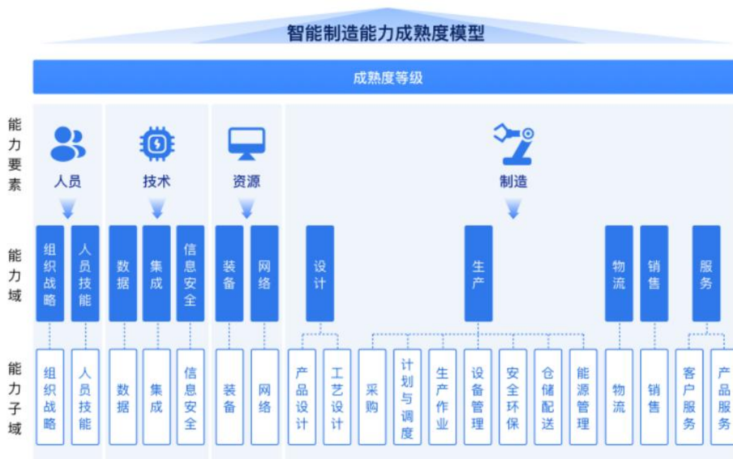
图 5-1 智能制造能力成熟度模型图
