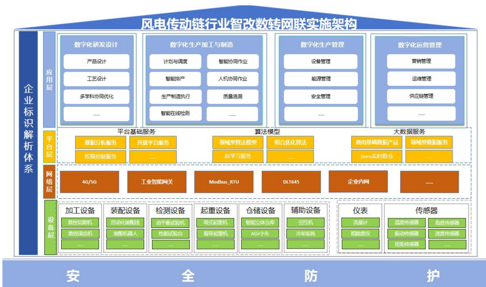
图 2-1 风电传动链行业智改数转网联实施架构图
