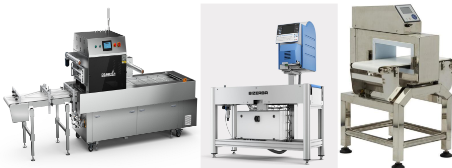
图 45 智能气调包装机、自动贴标机及金检仪
